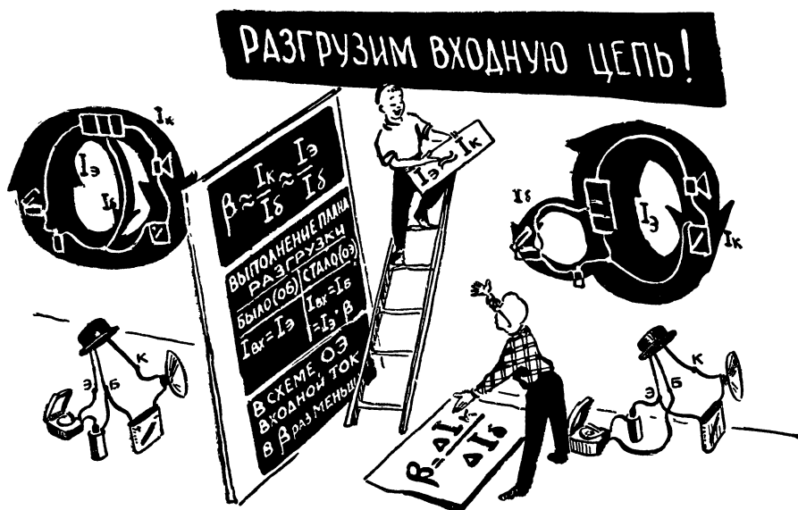
Рис. 69. Коэффициент усиления тока в схеме ОЭ— \beta , по сути дела, показывает, во сколько раз мы разгрузили входную цепь при переходе от схемы ОБ к схеме ОЭ.
